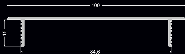
K4 powierzchnia wentylacji поверхность вентиляции 227 cm 2
